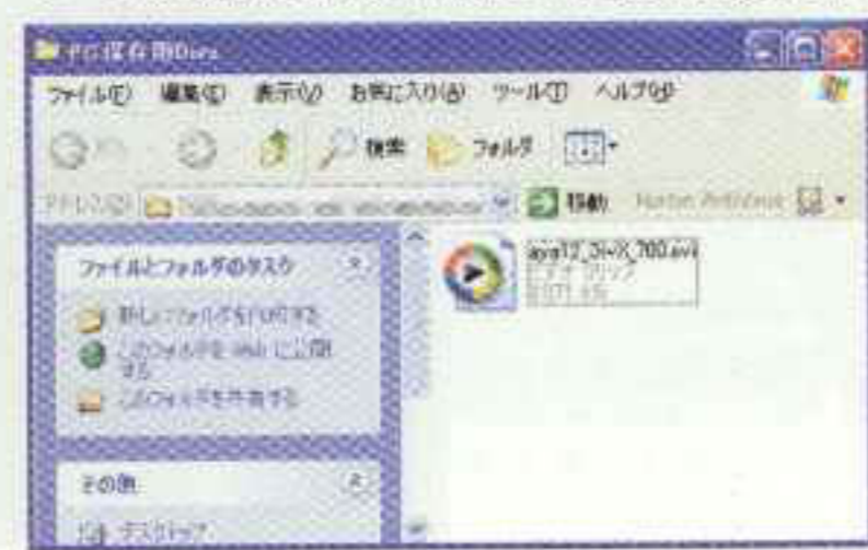
LANケーブルでつなぐと、PC上でHDR-3160はこうに見える。ネットワークが構築されていれば、もちろん複数のPCから見ることができる。
