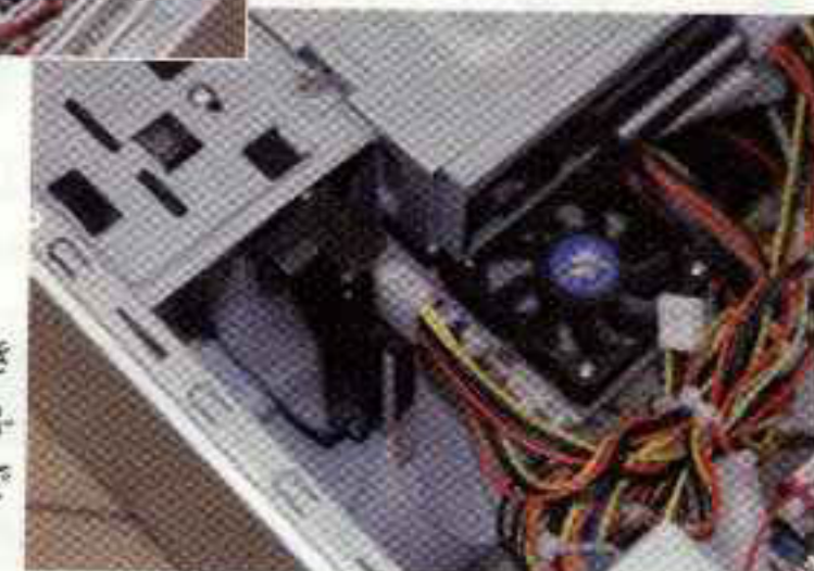
HDDを入れるスペース、空きIDEコネクタもあるので、HDR-3160をPCと考えれば増設もできそう。
